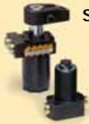
**Schwenkspan- und Abstützylinder**
