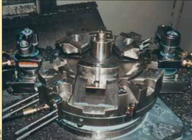
Die Spannarmer übertragen die von den Schwenkspannzylindern generierte Kraft auf das Werkstück. Spannarmer sind in verschiedenen Längen erhältlich. Sobald die erforderliche Spannarmlänge und Spannkraft feststeht, können Sie den Schwenkspannzylinder-Typ und die Spannmethod auswählen.
