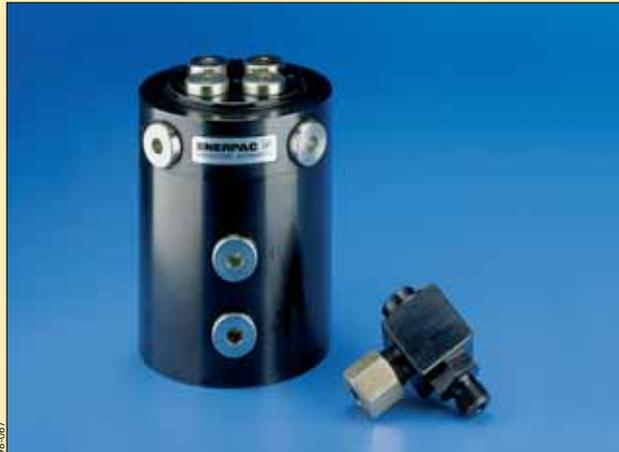
► Drehdurchführungen sind Anschlußelemente für Druckleitungen von einer feststehenden Hydraulikeinheit zu rotierenden Vorrichtungen. Sie werden beispielsweise für auf Rundschalttischen und rotierenden Fertigungsstationen montierte Bearbeitungs- und Spannvorrichtungen verwendet.
