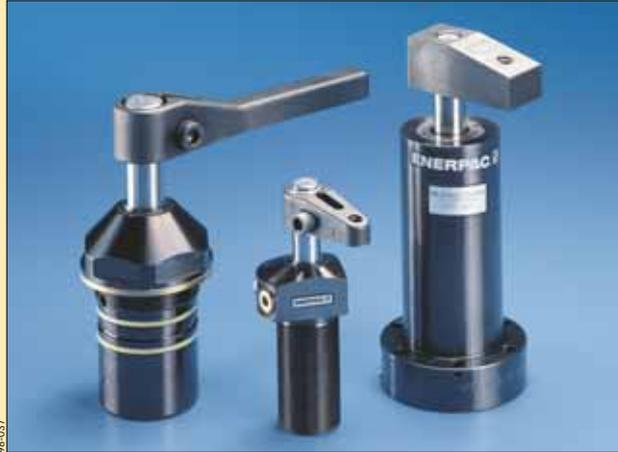
► Enerpac-Schwenkspannzylinder gestatten das frei zugängliche Spannen und Einlegen von Teilen in Vorrichtungen. Die Kolbenstange mit Spannarm dreht sich erst um 90 Grad links oder rechts herum und spannt dann das Werkstück durch weiteren vertikalen Hub. Nach dem Ablassen des Spanndruckes dreht sich der Spannarm um 90 Grad in die entgegengesetzte Richtung und gestattet hierdurch das Entfernen des vorhandenen und das Einlegen des neuen Werkstückes.
