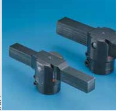
Die Spannarme dienen zur Kraftübertragung von den Schwenkspannzylindern auf die Werkstücke. Der T-Spannarm spannt zwei Werkstücke gleichzeitig mit einem Schwenkspannzylinder ein. Enerpac empfiehlt den Einsatz der T-Spannarme mit doppelwirkenden Schwenkspannzylindern der Baureihen SU, SL, ST und SC.
