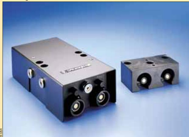
▶ Automatikkupplungen ermöglichen das An- und abkuppeln von Palettenspannsystemen der flexiblen Fertigung. Sie machen das Eingreifen durch den Bediener überflüssig und gewährleisten einen sicheren „freihändigen“ Betrieb. Das System besteht aus einem Festteil und ein oder mehreren Palettenteilen.
