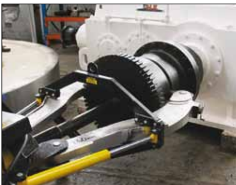
◀ Schnelle und einfache Demontage einer Antriebskupplung von der Antriebswelle mit dem EPH-1002E.
