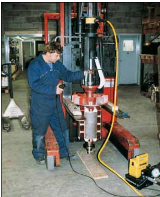
◀ Das Modell EPHR-116 wird für das Abziehen elektrischer Motorriemenscheiben verwendet. Der Abzieher wird mithilfe der Hebeplatte positioniert.
