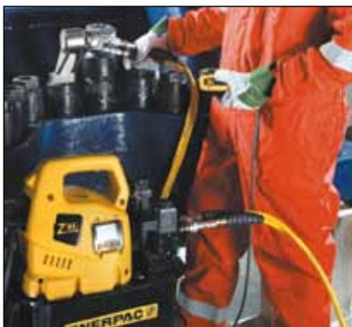
◀ Hydraulik-Drehmomentschlüssel jeder beliebigen Marke können mit den tragbaren Drehmomentpumpen der ZA4T-Serie betrieben werden
