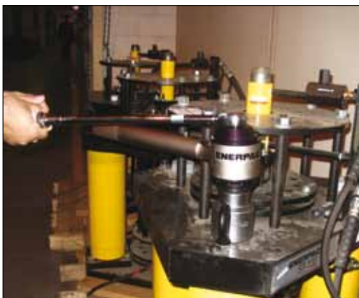
◀ Enerpac Drehmomentvervielfältiger E393 zum manuellen Festziehen und Lösen von Schrauben mit bis zu 4300 Nm.
