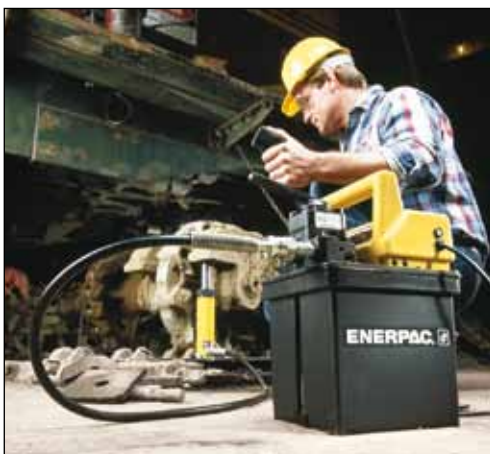
◀ Ein Modell mit Handventil und Motorfernsteuerung vereinfacht die Reparaturarbeiten an diesem Baukran.
