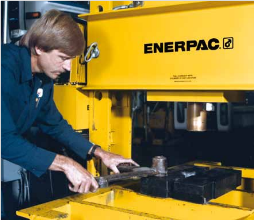
▲ Eine BPR-20075 Rollrahmen-Pressen wird zur Entfernung einer großen Welle von einem Lagerbock-Aufbau eingesetzt. Die Rollrahmen-Konstruktion ermöglicht die sichere Beladung dieses schweren Teils mit einem Laufkran.
